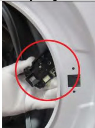
2.4 Remove the door lock
