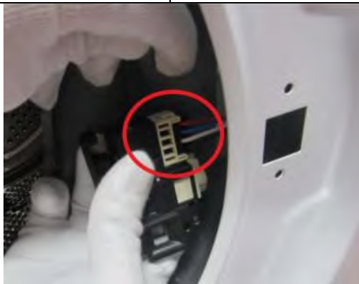
2.4 Remove the door lock
