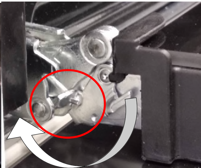
Charnière côté gauche déverrouillée
