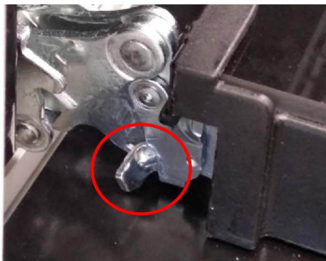
Charnière côté gauche verrouillée
