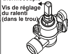
Vanne sans thermocouple
